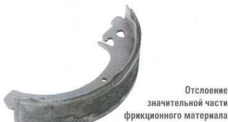
Отслоение значительной части фрикционного материала
