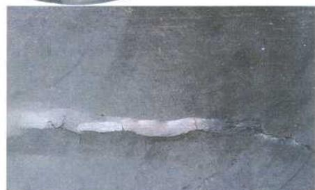
Нанесение материала на рабочую поверхность барабана
